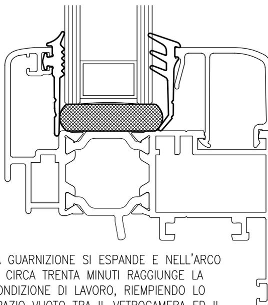
LA GUARNIZIONE SI ESPANDE E NELL'ARCO DI CIRCA TRENTA MINUTI RAGGIUNGE LA CONDIZIONE DI LAVORO, RIEMPIENDO LO SPAZIO VUOTO TRA IL VETROCAMERA ED IL PROFILO, CREANDO UNA BARRIERA AL FLUSSO DEL CALORE
