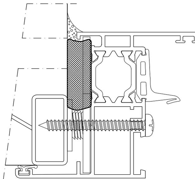
LA GUARNIZIONE SI ESPANDE E NELL'ARCO DI CIRCA TRENTA MINUTI RAGGIUNGE LA CONDIZIONE DI LAVORO, ANDANDO A RIEMPIRE GLI SPAZI VUOTI, CREANDO UNA BARRIERA AL FLUSSO DEL CALORE E FAVORENDO L'ISOLAMENTO ACUSTICO DEL SERRAMENTO. SUCCESSIVAMENTE, EFFETTUARE LA SIGILLATURA TRA TELAIO E MURATURA
