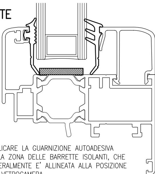
APPLICARE LA GUARNIZIONE AUTOADESIVA NELLA ZONA DELLE BARRETTE ISOLANTI, CHE GENERALMENTE E' ALLINEATA ALLA POSIZIONE DEL VETROCAMERA
